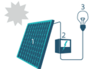
1. Zonnepaneel | 2. Omvormer | 3. Elektrische toestellen
